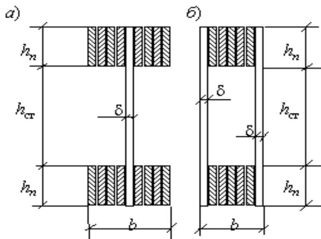
Рис. 4. Поперечные сечения клееных балок с плоской фанерной стенкой
