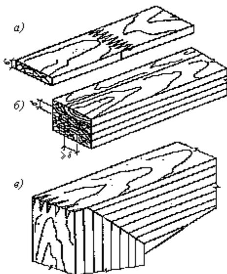
Рис. 6. Клеевые соединения
