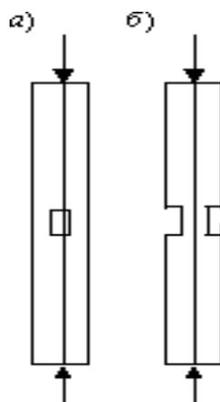
Рис. 1. Ослабление сжатых элементов
