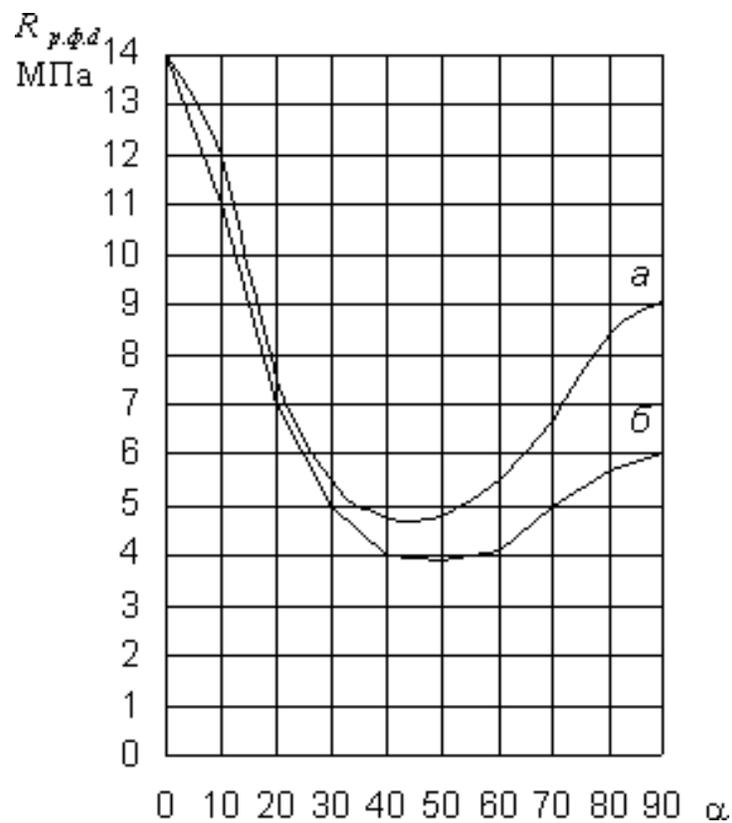
Рис. 17. Графики для определения расчетных сопротивлений при растяжениях под углом к волокнам наружных слоев березовой фанеры марки ФСФ
