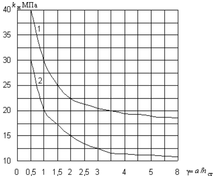
Рис. 18. Графики для определения коэффициента  $k_{и}$  при расположении волокон в наружных слоях фанеры вдоль пролета
