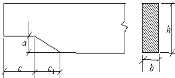
Рис. 15. Скошенная подрезка конца балки
