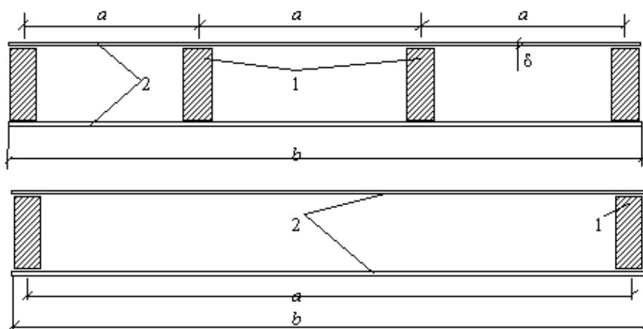
Рис. 3. Поперечное сечение клееных плит из фанеры и древесины
